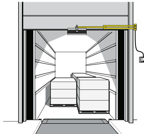
Кронштейн с прожектором устанавливается внутри помещения в непосредственной близости от края проема. Кронштейн с двумя поворотными осями и подвижное крепление светильника позволяют точно позиционировать положение прожектора и добиться максимальной освещенности пространства внутри кузова автомобиля.
