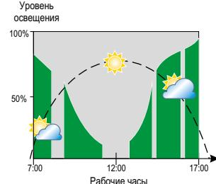
Потребление электроэнергии при использовании стандартного балласта без регулировки яркости
