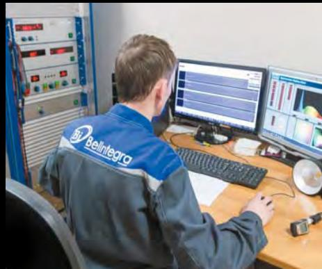
Совместно с гониофотометром работает колориметрическая система на базе спектрометра "SM 8107" фирмы LMT. Современная климатическая система ведущего производителя "WEISS Umwelttechnik GmbH" (Германия), позволяет проводить климатические испытания в диапазоне температур от -72 до +180°C. В силу полностью автоматизированных циклов измерений, данные системы позволяют достигать высокой точности измерений и исключить человеческий фактор на стадии снятия параметров.
