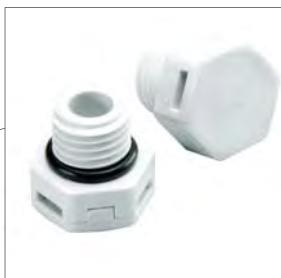
Клапан выравнивания давления служит для предотвращения образования конденсата в светильнике. Устанавливается в корпус светильника и регулирует давление, температурный режим и обеспечивает вентиляцию.
